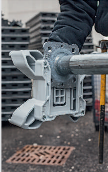
픽스 헤드 디에프에이치는 모서리 길이 120 mm 이하 그리고 두께 5 ~ 8 mm의 엔드 플레이트 (End plates)에 밀어 넣어 고정시킬 수 있다.
