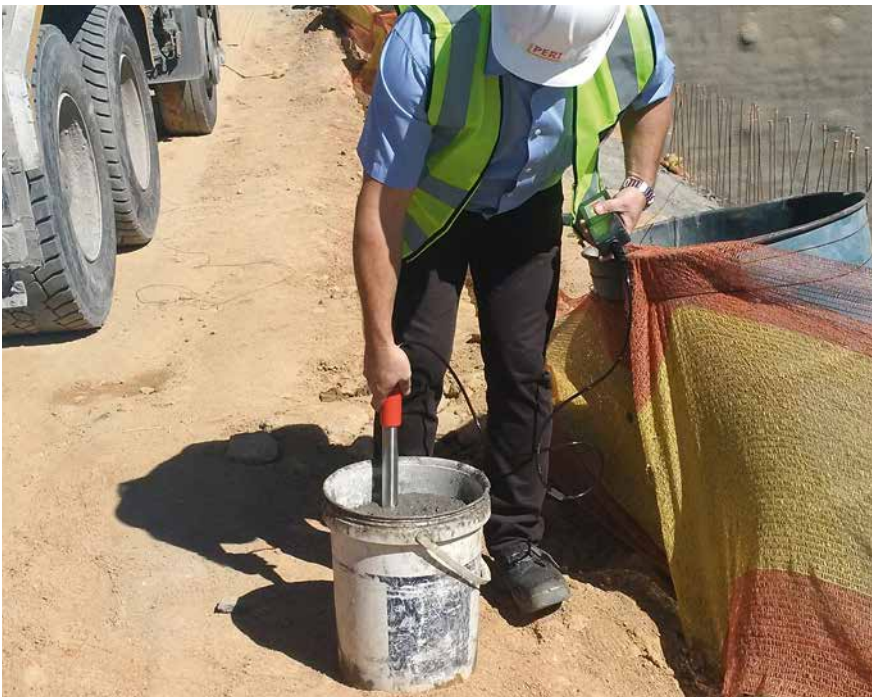
PERI SONO 분석기는 측정 프로브와 디스플레이가 있는 이동형 계측기로 구성됩니다. 프레쉬 콘크리트 측정은 일반 플라스틱 버킷을 이용합니다.
